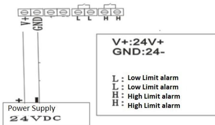
L-L es el interruptor de alarma de límite bajo. Cuando el caudal es inferior al valor configurado, los dos terminales pasan de desconexión a conducción; cuando la presión es superior al valor configurado, los dos terminales cambian de conducción a desconexión.
